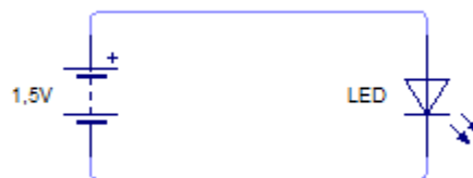
Figura 7. Diagrama de un circuito eléctrico con un led y una pila
